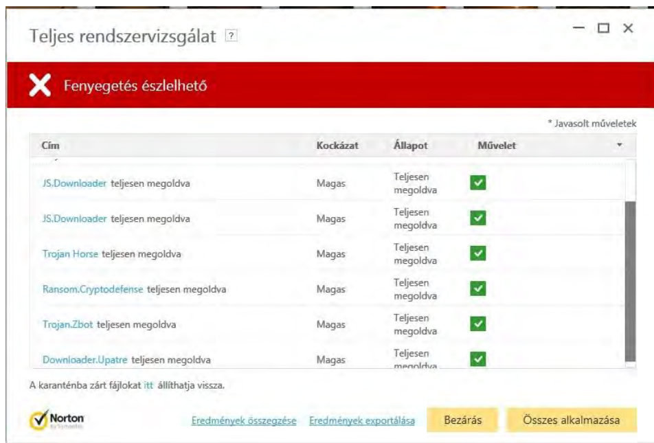
50. ábra – Teljes rendszervizsgálat eredménye, ha vírusos a vizsgált számítógép
