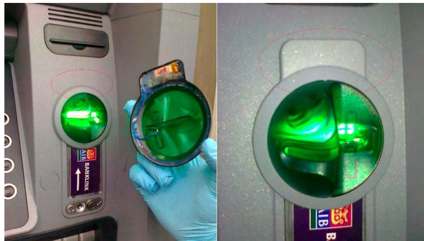
53. ábra – Kártyamásoló eszköz ATM-en
