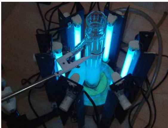
1.25. ábra. Folyadékfázisú vizsgálatokhoz használt, házi építésű reaktor
